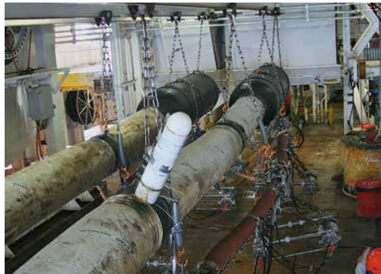
«Сейсмокосы» — зонды для исследования шельфа сейсмическим способом
