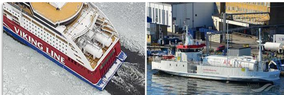
Рисунок 13: размещение емкостей для СПГ на корме парома и баржа-бункеровщик Seagas4
