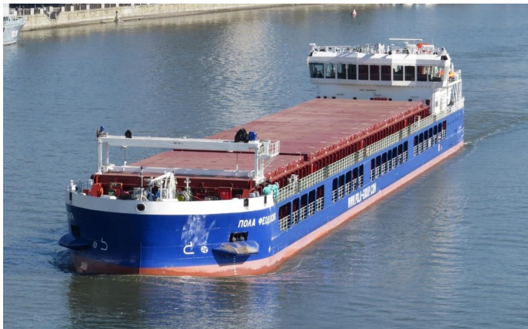
Рисунок 37: ПРОЕКТ RSD59 Многоцелевое сухогрузное судно дедвейтом 8144 / 5320 тонн типа "Пола Макария" класса "Волго-Дон макс" (построено 13 судов , в постройке – 27 судов, в опционе – 20 судов)
