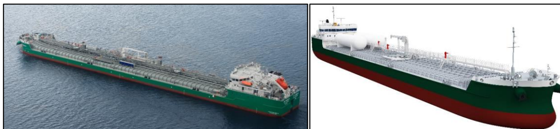
Рисунок 38: ПРОЕКТ RST27 Танкер - продуктово-химовоз дедвейтом 7030 / 5428 тонн типа «ВФ Танкер» класса «Волго-Дон макс» (построено 47 судов (2012 – 2018 годы))
