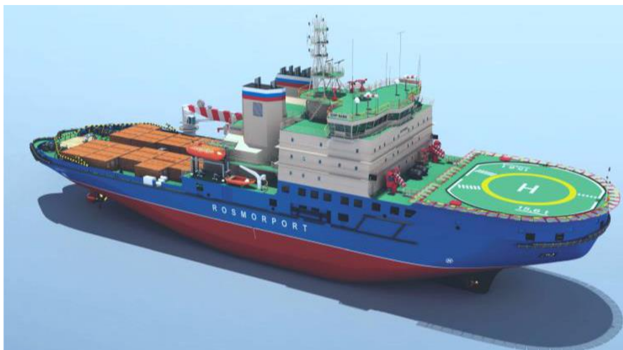
Рисунок 35: проект ледокола мощностью 18 МВт ледового класса Icebreaker7
