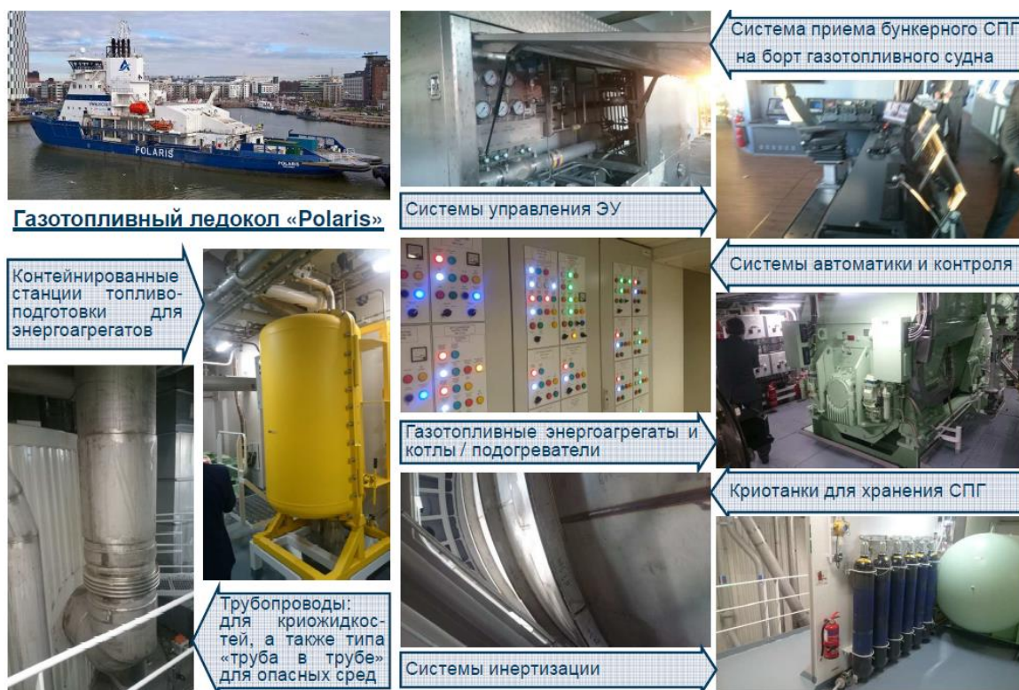
Рисунок 48: газовое и СПГ-оборудование для газотопливных судов (на примере ледокола «Polaris»).
