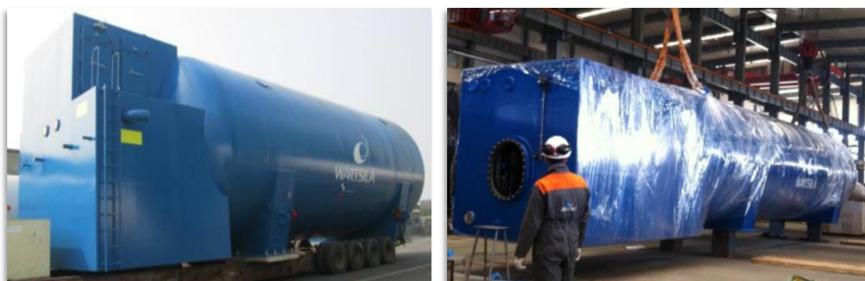
Рисунок 49: судовые топливные СПГ-баки объемом 230м³ (справа) и 45м³ (слева)
