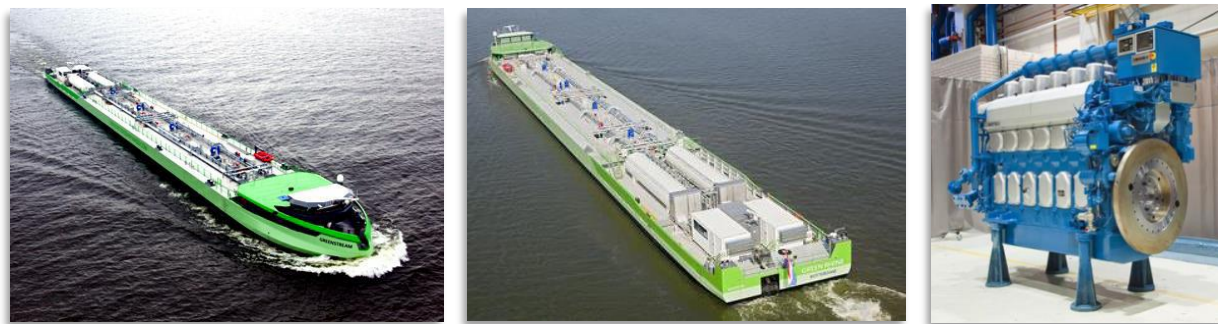
Рисунок 28: баржи Greenstream и Greenrhine на СПГ (газодизель-генератор)
