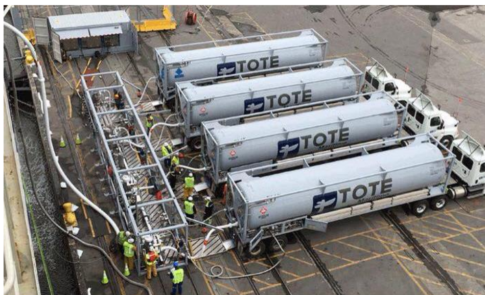
Рисунок 58: одновременная бункеровка несколькими КриоПАГЗ через общий коллектор
