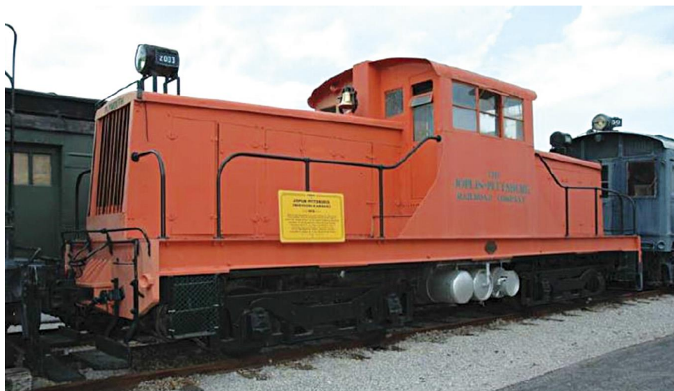
Рисунок 1. Экспериментальный локомотив Plymouth ML с газопоршневым двигателем, сейчас экспонат Музея транспорта в г. Кирквуд, штат Миссури, США
