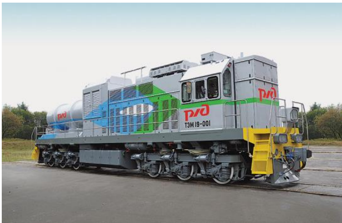
Рисунок 12. Маневровый тепловоз на СПГ ТЭМ19
