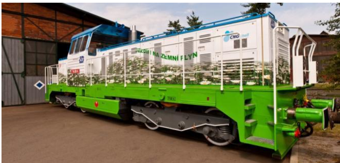
Рисунок 6. Локомотив на КПГ компании АО «ВИТКОВИЦЕ Транспорт»
