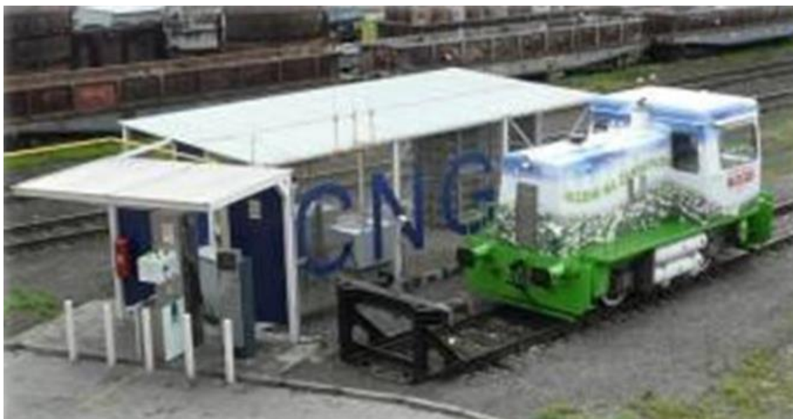
Рисунок 7. Заправка локомотива на КПГ компании АО «ВИТКОВИЦЕ Транспорт»
