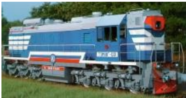
Рисунок 11. Маневровый тепловоз на КПГ ТЭМ18Г
