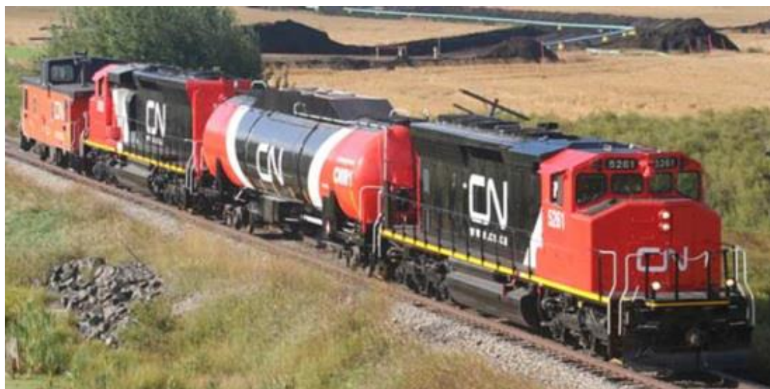
Рисунок 5. Локомотив на СПГ компании «Canadian National Railway»
