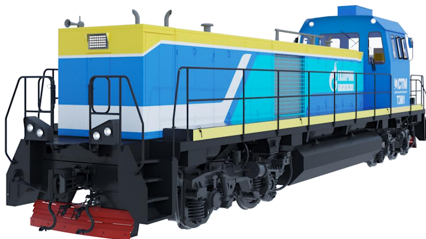
Рисунок 26. Маневровый тепловоз на СПГ ТЭМГ1
