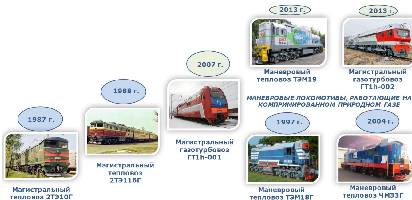
Рисунок 13. Эволюция производства газовых тепловозов на СПГ
