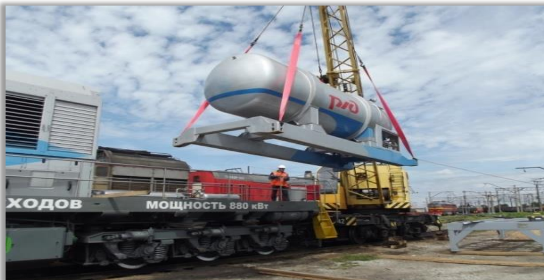
Рисунок 20. Замена емкости СПГ маневрового тепловоза на СПГ ТЭМ19
