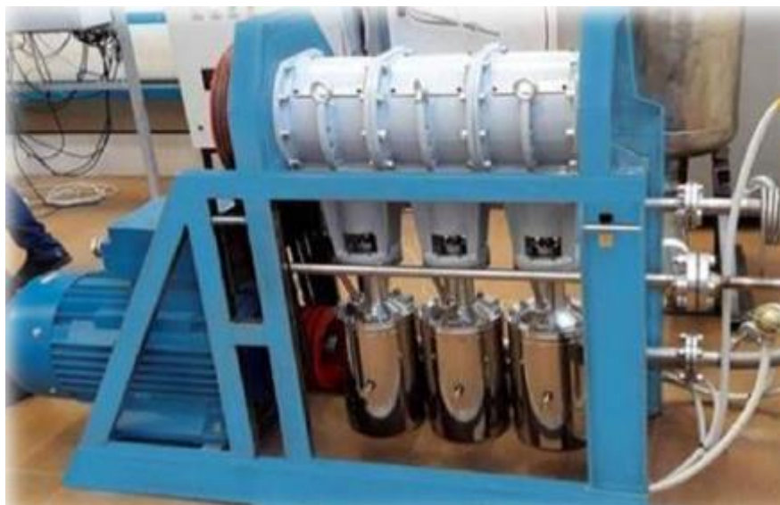
Рисунок 16. Криогенный насос АНМ-100.5ХА
