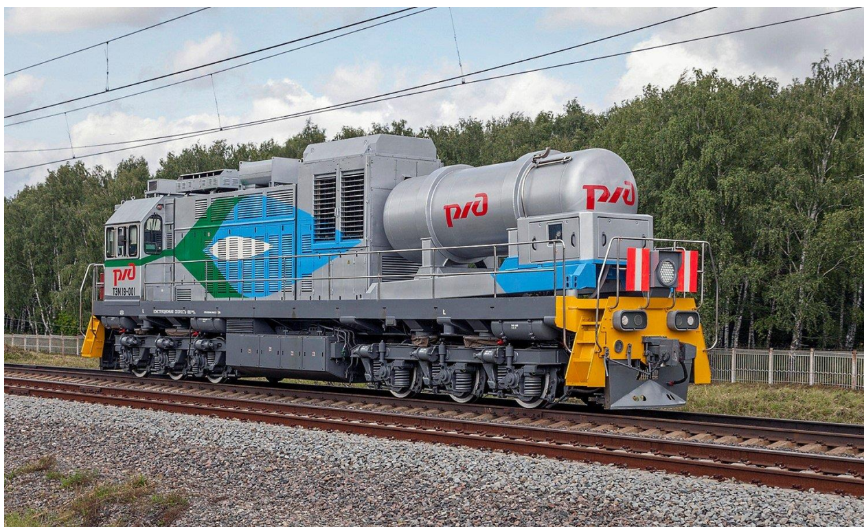
Рисунок 19. Маневровый тепловоз на СПГ ТЭМ19
